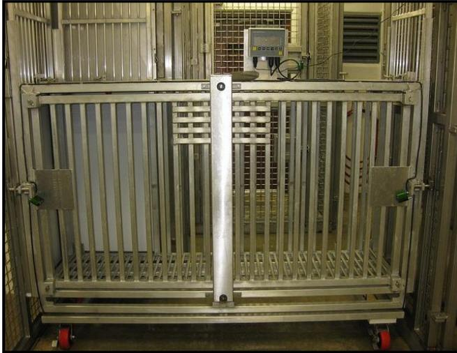
Rampa transportadora de contención con balanza.
